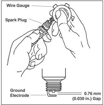
Figure 16. Servicing Spark Plug.
